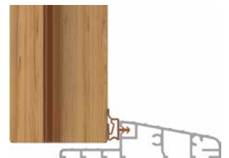
próg z uszczelnieniem
